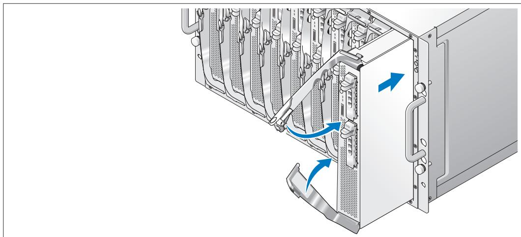
Postupujte zleva doprava a zasouvajte moduly do šasi. Jakmile se otevřené rukojeti dotknou předního panelu šasi, začněte otáčet společně rukojetmi (dolní rukojet se zavře jako první), dokud nebude dolní rukojet lícovat s předním panelem modulu. Pokračujte v otáčení horní rukojeti dolů, dokud nebude lícovat s dolní rukojetí. (Jakmile jsou rukojeti rádně zavřené, uvolňovací západka zajistí obě rukojeti k přednímu panelu.)
