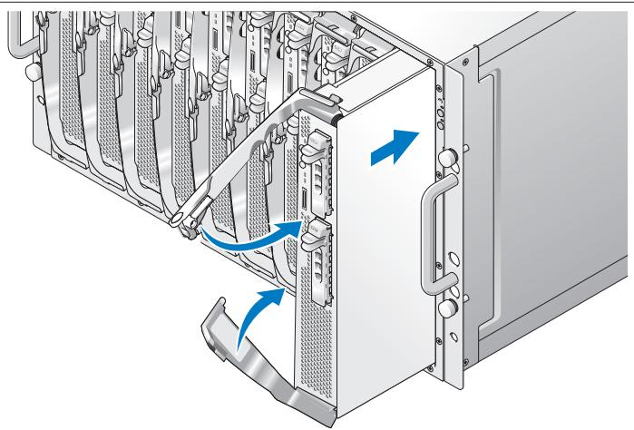
Начиная с левого края, вставьте модули в корпус. Как только открытые ручки коснутся передней панели корпуса, начните одновременно закрывать обе ручки (нижняя ручка закроется первой) до тех пор, пока нижняя ручка полностью не войдет в переднюю панель модуля. Продолжайте поворачивать верхнюю ручку вниз до тех пор, пока она не совпадет по уровню с нижней ручкой. (После полного закрытия ручек защелка должна зафиксировать обе ручки на передней панели.)
